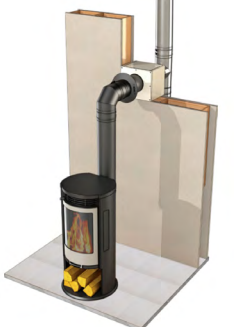
Optional: Wanddurchführung mit Anschlussplatte 20 mm und Spezialdichtung für die einfache Anbindung der Dampfsperre.
